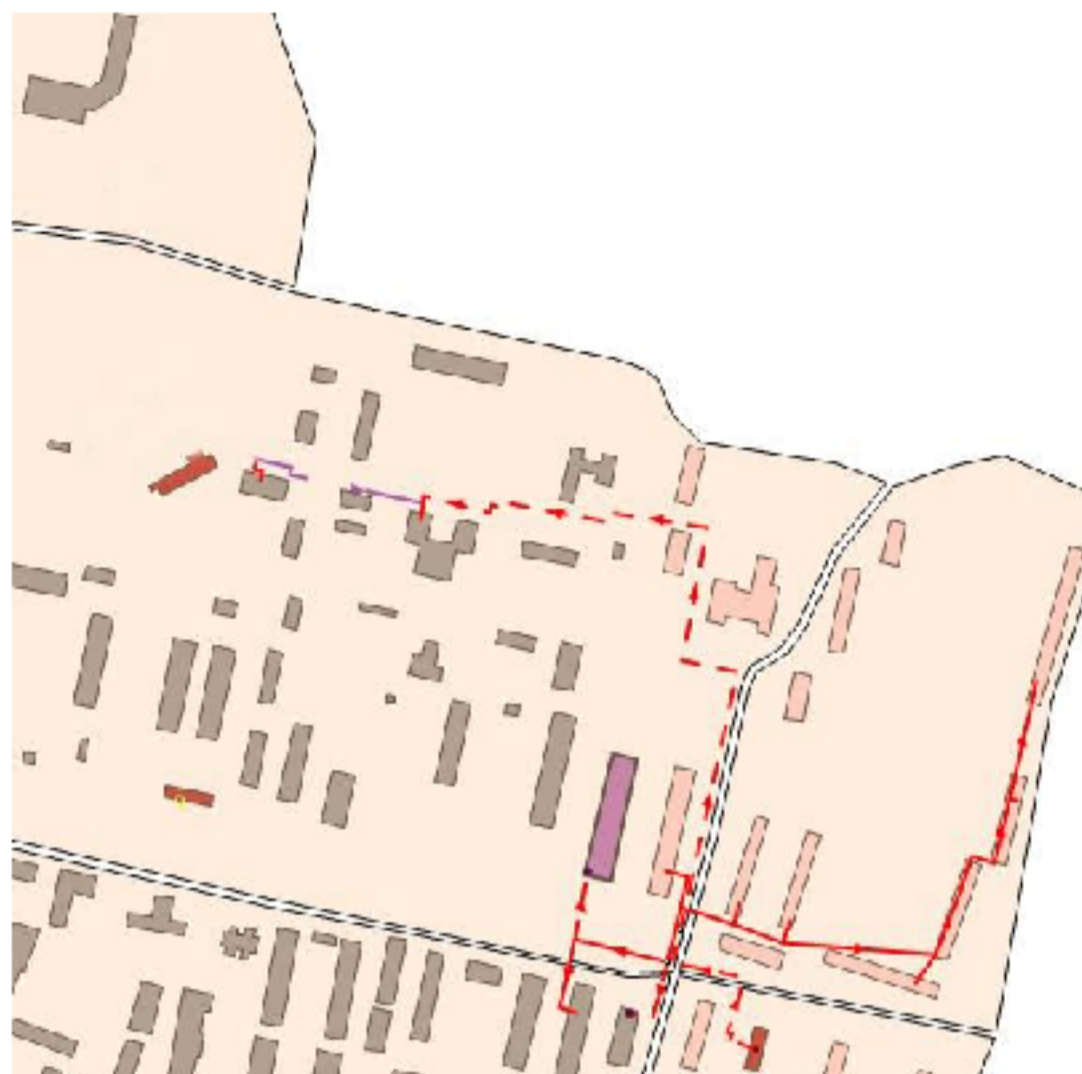
Рисунок 8 – Схема объединенной тепловой сети системы ГВС после осуществления второго этапа реконструкции (общий вид)
