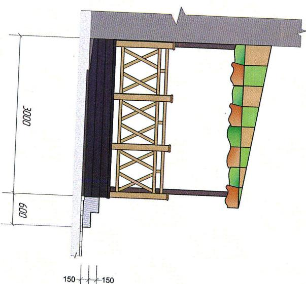
Каркас террасы выполнен из пепелопраката квадратного сечения на болтах соединениях. Основанием для каркаса служит бетонное мембранные стяги.
